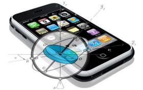
Les gyroscopes qui équipent certains smartphone servent à repérer précisément la **position** et l'**orientation** de l'**appareil dans l'espace**.
